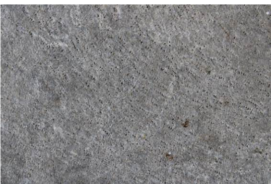
Εικ. Β2 Λεπτομέρεια επιφάνειας ακατέργαστου θραύσματος από γκρίζο μάρμαρο από το λατομείο της Πηγής Λέσβου που προσομοιάζει μακροσκοπικά με τα μάρμαρα που έχουν χρησιμοποιηθεί στο Κάστρο Μυτιλήνης.
