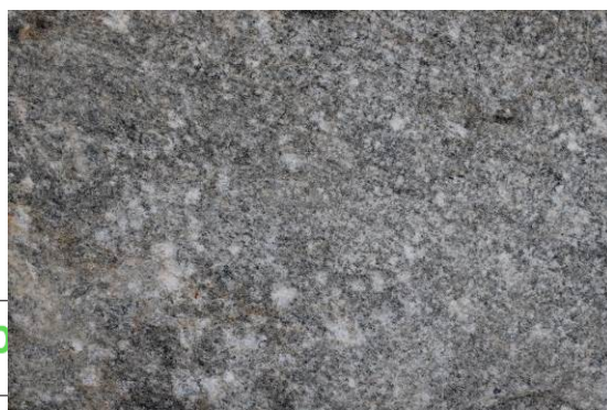
Εικ. Β2 Λεπτομέρεια επιφάνειας ακατέργαστου θραύσματος από γκρίζο μάρμαρο από το λατομείο της Πηγής Λέσβου που προσομοιάζει μακροσκοπικά με τα μάρμαρα που έχουν χρησιμοποιηθεί στο Κάστρο Μυτιλήνης.
